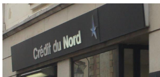
Exemple de caissons lumineux à fond sombre (hors commune) Seules les lettres sont lumineuses.
